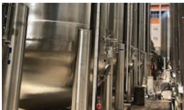
4 tanques autoclaves para elaboração de espumantes de 56 mil litros – Unidade Matriz.
