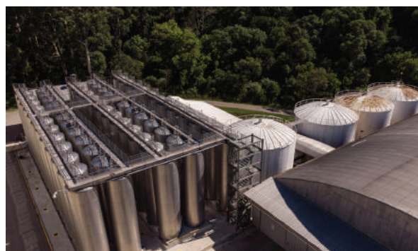
20 tanques de 500 mil litros para estocagem de vinhos e suco – Unidade Vinhedos.
